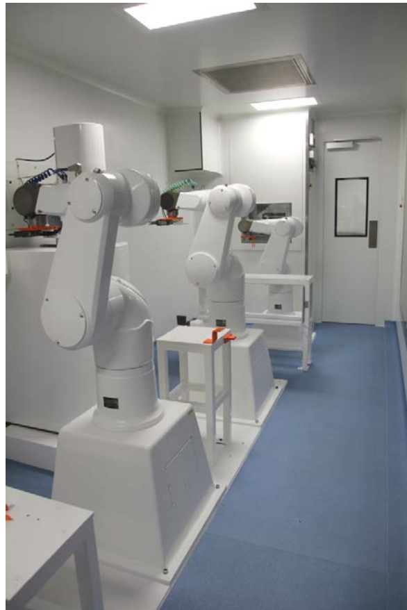
Fig.1. Algemeen beeld van de gerobotiseerde lijn van TEXERE voor de productie van botallograften.
